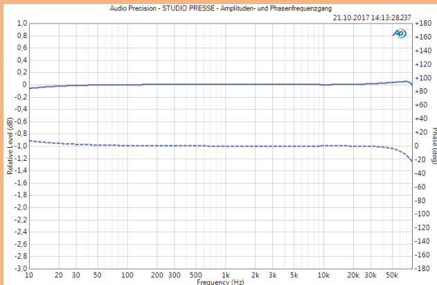
Diagramm 3: EQ1 – Amplituden- (solide) und Phasenfrequenzgang (gestrichelt) im Neutralzustand
